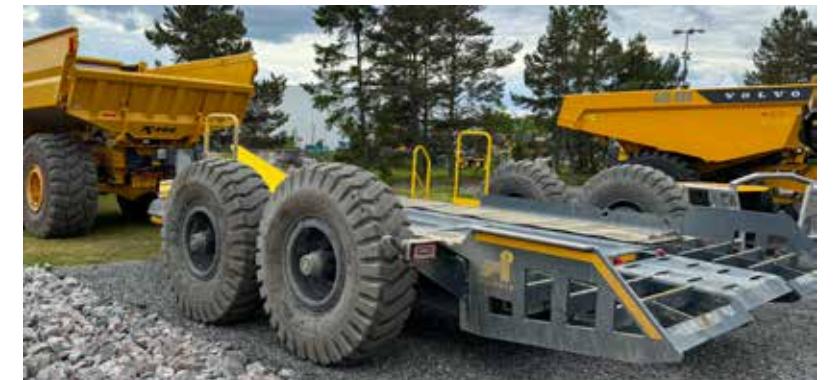
På området for spesialproduksjon var denne maskinhengeren for bruk etter dumper. Finskproduserte Slepner DB45 kan belastes med 45 tonn.
