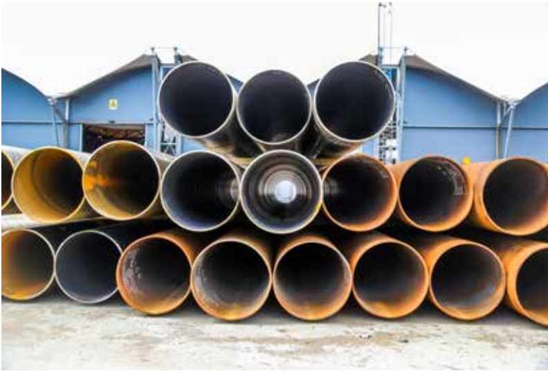
Hele 84 stålrørspeler som disse, rammes ned i fjell før de armeres og støpes ut.
