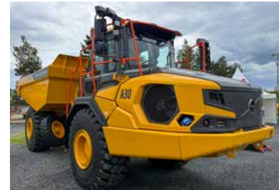
2-akslet Volvo-dumper 4x4 med «støttehjul». Den er konstruert for bruk i mindre tunneler og når den kommer tom inn på stuff, senkes støttehjulene og dumperen kan enkelt snu inne i tunnelen.
