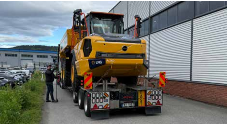
Siste sjekk av høyden før transporten av el-dumperne.
