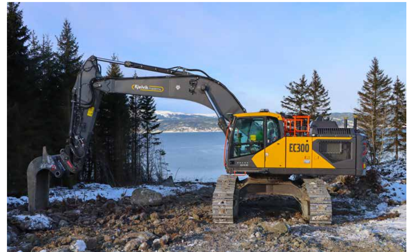
Volvo EC300F High Walker har undervogna til EC400, og er både høyere, bredere og tyngre enn standard EC300-graver.
