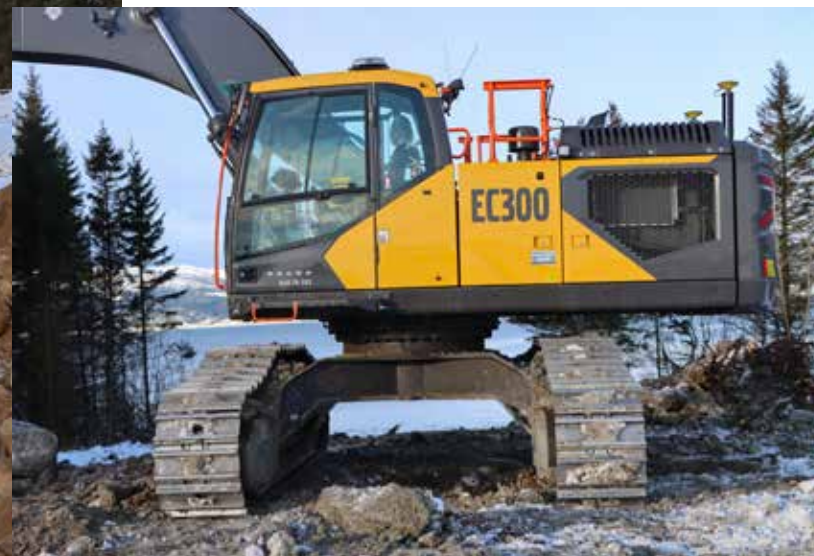
Undervogna på EC300F High Walker har bakkeklaring på 74 cm, lengden er 499,5 cm og den er 342 cm bred. I tillegg har den hele beltestyringer og kraftigere bukplater.
