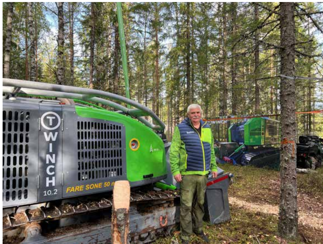
Frivik er også importør av T-Winch fra Ecoforst GmbH. Dette er en vinsj for å holde andre maskiner i bratt terreng.
