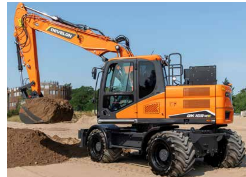
DX160WE-7K er en elektrisk hjulgraver på 19 tonn med batterikapasitet på 380 kWh. (Foto: Develon)
