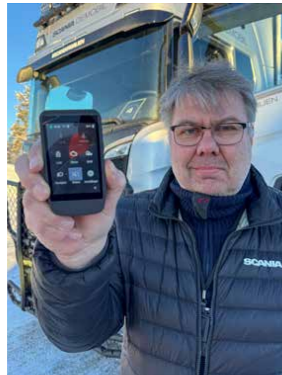
Espen Braata i Norsk Scania med den håndholdte fjernkontrollen Pro Remote 2. Fjernkontrollen gjør det mulig å betjene sentrale kjøretøyfunksjoner utenfor førerhuset, som blant annet styre kraftuttak, luftfjæring, starte og stoppe motoren, lese av vekter og betjene utvalgte lysfunksjoner. Løsningen er spesielt relevant for tømmerbiler og kranbiler, der mye av arbeidet foregår fra kranhytte eller bak på kjøretøyet.
