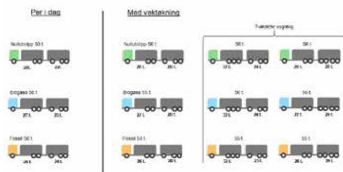
Illustrasjon som viser fordeling av vekt på bil og henger.
