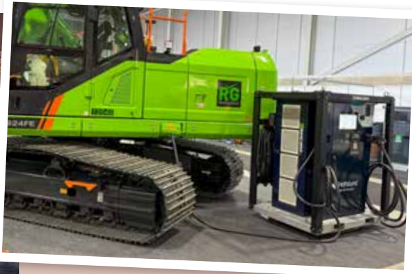
LENGSTE PÅ MESSA: Rental Group (RG) hadde tatt med den første Liugong langgraveren de har fått inn i utleieparken til messa. Den er også den første i Europa. Langgraveren Liugong 924 FE SLR veier 26,5 tonn og har maks rekkevidde på 15,6 meter. Batterikapasiteten er på 423 kWh, den kan lades med DC-lader (hurtiglader) og kan ta i mot hele 350 kW. – Langgraveren er basert på en standard Liugong 924, som vi allerede har tolv av i utleieparken. Så langt er det ingen som har klaget på batterikapasitet eller ladehastighet, sier Magnus Andreassen, salgsansvarlig distrikt hos Rental Group. RG viste også frem lademuligheter som de tilbyr gjennom samarbeid med Hafslund.
