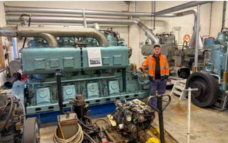
Bjørn var maskinist på båt i mange år, og hans store interesse er båtmotorer, og helst norsk-bygde. De fleste han har i samlingen er møysommelig plukket fra hverandre, overhålt og satt sammen igjen. Motoren på bildet er modell 4M fra Brødrene Brunvoll Motorfabrikk. Den ble bygget i kun åtte eksemplarer i årene 1958-60, og yter 280 hk. Denne motoren satt opprinnelig i båten «Suløy». De resterende sju motorene er for lengst blitt til spiker.
