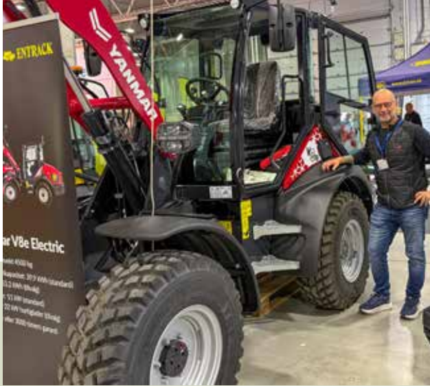
NORGESLANSERING: Hans Christian Hagen hos Entrack viste blant annet frem den helt nye elektriske Yanmar V8e. Den veier 4500 kg, standard batterikapasitet er 39,9 kWh, men kan også leveres med en batterikapasitet på 53,2 kWh. Maks ladekapasitet er 22 kW. – Dette er den første i Norge, og kom direkte hit til messa. Den skal nå på test noen måneder ute hos kunde her i Norge, sier Hagen.
