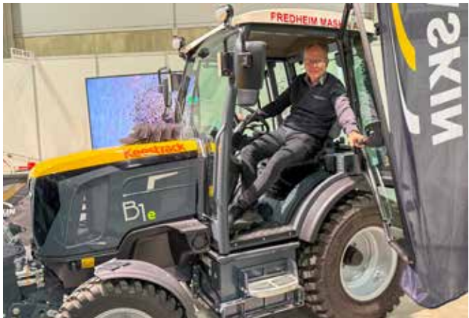
EL-TRAKTOR: Per Olav Fredheim i Fredheim Maskin hadde tatt med el-traktoren de fikk i sortimentet tidligere i år. Keestrack B1e traktor har firehjulsdraft, 40 km/t topphastighet, PTO kraftuttak i front og bak (elektriske – 14kW og 9,5kW), batterikapasiteten er på 58 kWh (22 kW lader), den veier 2,3 tonn, og kan trekke en henger på 3,5 tonn.
