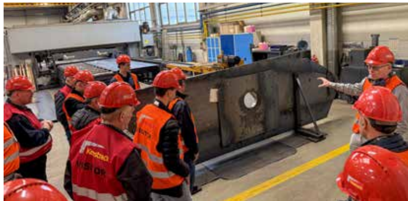
Det kommer inn ca. 1000 tonn stål per måned til fabrikken. Her er siktesiden til en Keestrack K5 ferdig skjært ut, og klar for videre behandling.
