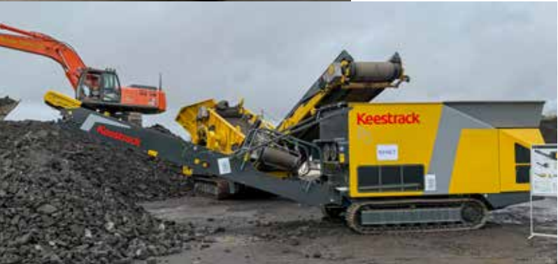
Dette er den nye kverna Keestrack P3. Den er en kompakt 2-akslet saktegående avfallskvern på 16 tonn, og er beregnet for rivningsmateriale, trevirke, grønt, trær/røtter, avfall, dekk, asfalt med mer.
