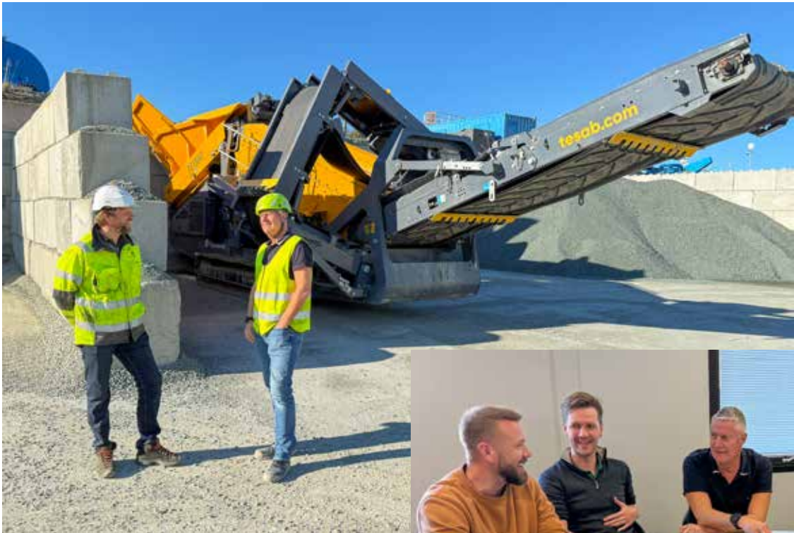
Odd Einar Nørjordet (t.v.), produksjef hos Kiesel Norge AS, og Sturla Sørhøy, daglig leder Rimol Miljøpark, foran det nye Tesab TS1550 2-dekkssikte. – TS1550 er kjent for å levere høy ytelse, også i krevende og klebrige masser. Den store sikteflaten og robuste konstruksjonen gjør at massene sorteres effektivt, noe som gir et rent og kvalitetsmessig stabilt produkt, forklarer Nørjordet.
