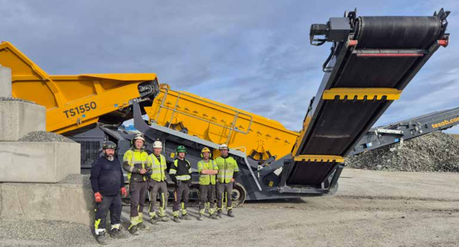
Bildet ble tatt i forbindelse med igangkjøringen av Tesab-verket. TS1550 har bred innmatingsåpning, siktekasse på 4,88 m x 1,53 m og veier 32,6 tonn. Maskinen ble levert med full igangkjøring, operatørutpløring med teknisk gjennomgang og dokumentasjon. Kiesel tilbyr telematikk-løsning for løpende overvåkning av driftstimer, serviceintervaller og nøkkeltall.
