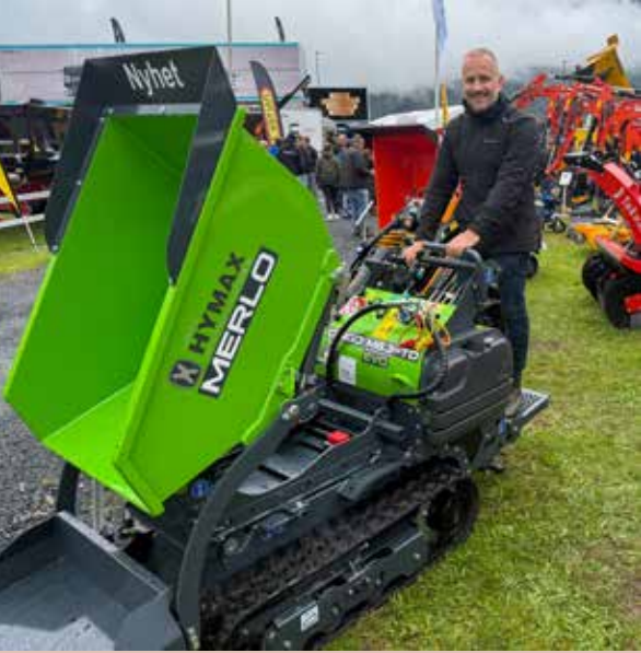
MULTIMASKIN: Torgeir Nustadhaugen, produktsjef hos Hymax, med den første Merlo Cingo M8.3-TD som er på norsk jord. – Den har 800 kg nyttelast, er utstyrt med en 17 hk 2-sylindret vannavkjølt Kubota-motor, sier Nustadhaugen, og forteller man kan sette på støttebein, koble av kassa og rygge maskinen vekk slik at kassa står igjen. I stedet kan man sette på en betongblander eller en kasse med nedfellbare lemmer på sidene. Det skal også komme flere redskaper til modellen fremover.
