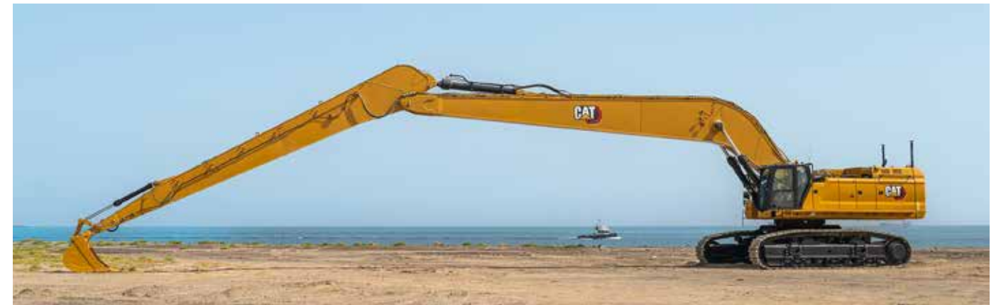
Cat 395 med LRE-settet veier litt over 113 tonn og har 28-meters rekkevidde.
