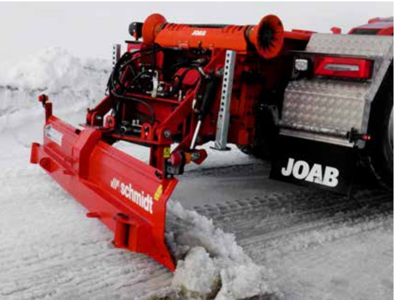
Påbygget på lastebilen er en krokloft levert av JOAB, og i tillegg har den en etterhengende skrape som kan brukes til å høvle ned is- og snøsale på veien. (Foto: Norsk Scania)
