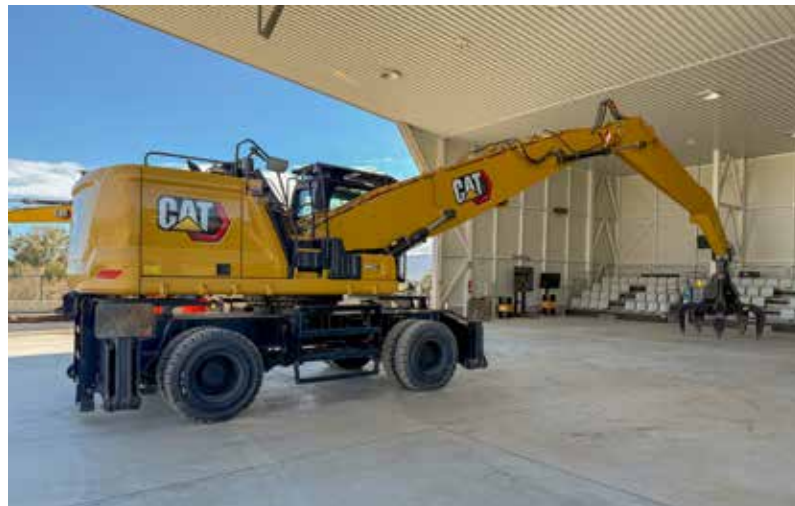
MH 3032 på 33,5 tonn skal fylle gapet mellom de to eksisterende MH3026 og MH3040.
