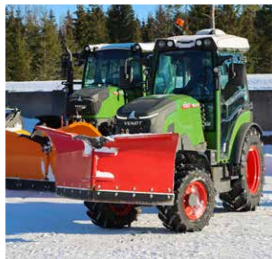
Den elektriske Fendt e107 Vario har en elektrisk motor på 55 kW (75 hk) og en batteripakke på 100 kWh. Når mer ytelse kreves, kan traktoren gi en kortvarig effektøkning til 66 kW (90 hk). Fendt oppgir en batteritid på mellom 4 og 7 timer, og skal ifølge Halstvedt hos Eiksenteret ha klart snørydding med skjær i syv timer. Riktignok ikke under store snømengder.
