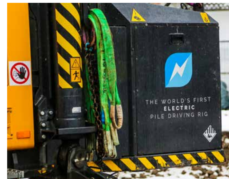
Junttan PMx2e er verdens første elektriske pelerigg.
