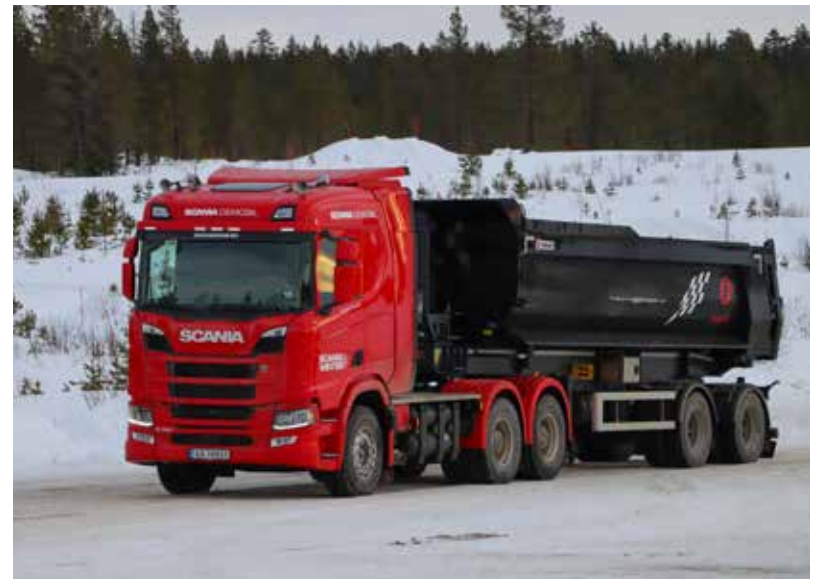
Scania R460 6x4 CNG er nå tilgjengelig med mer tankkapasitet. Den er blitt utstyrt med ekstra gasstanker montert bak førerhytta og har nå totalt 234 kg.
