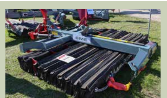
Foss Mekaniske Verksted AS (FMV) kjøpte merkevaren, produktrettigheter og produksjonsutstyr for Drammens-slodden og Drammensmatta rett før fjorårets messe. De hadde med seg flere nyheter til Seljord, blant annet denne versjonen av Drammessloddene. Den er utstyrt med løfte-ramme med kantvinge og utskiftbart slitestål. Dette skal gi enda bedre brukeregenskaper ut av Drammessloddene ved vedlikehold av grusveier.
