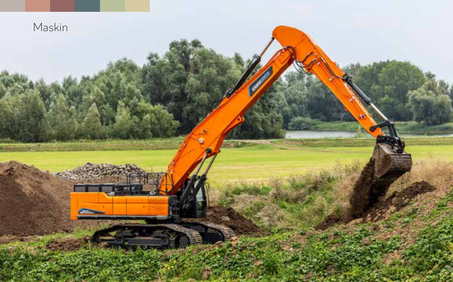
Den batterielektriske DX555 LC-7 veier 55 tonn og er basert på dieselmotoren Develon DX490 LC-7. (Foto: Staad Group)
