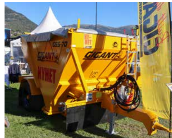
Mørk Maskin stilte med flere nyheter, blant annet strøvnogn GSS-70. Den har 7 m 3 kasse til strøsand, salt og grus opp til 32 mm. Spreddebredde fra 2,2 til 2,8 meter, og har en egenvekt på 3500 kg.
