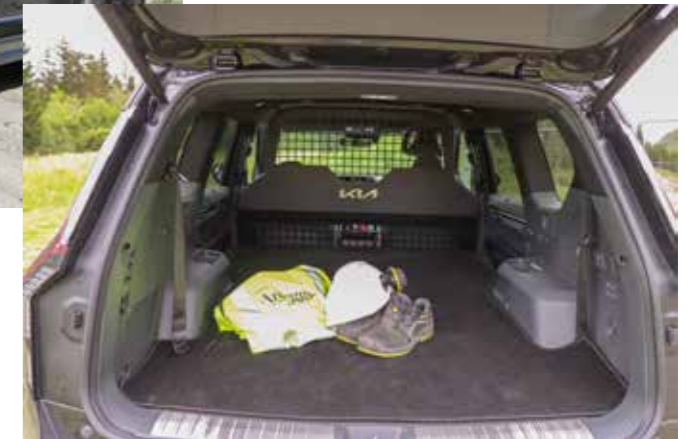
Lengden på varerommet i EV9 er over to meter. Åpningen er 73 centimeter høy. I versjonen med dobbelt gulv blir det én høyde på hele gulvet.
