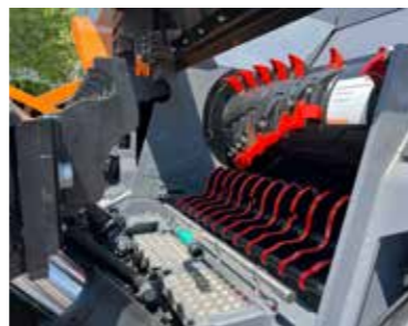
Doppstadts nye saktegående grovkvern, Inventhor 6.2, har 0-30 o/min og kan brukes til alle typer avfall.
