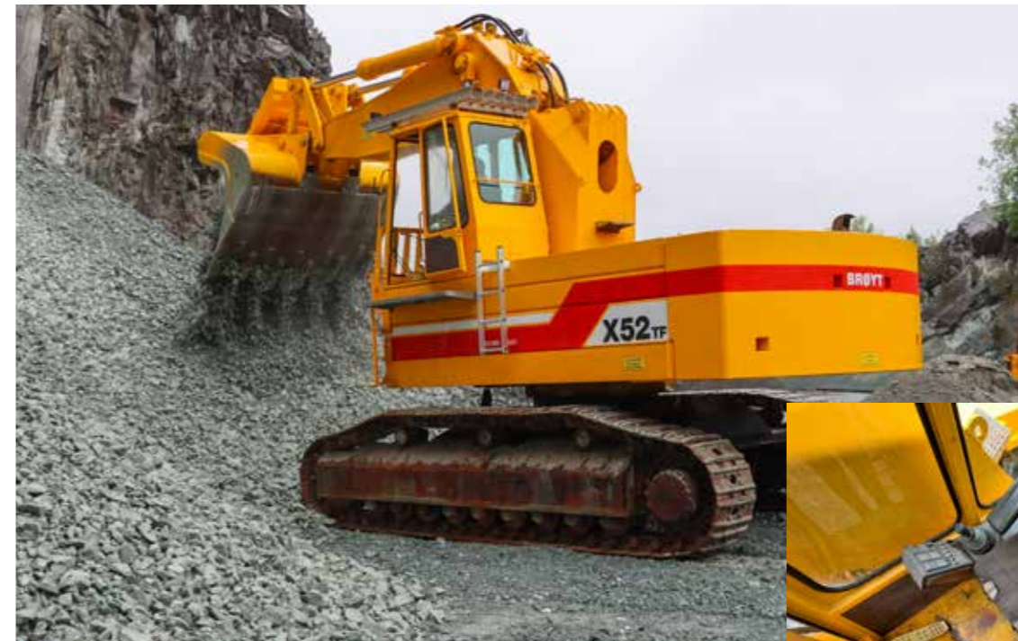
Brøyt X52 ble levert enten med hjul eller belter. Beltemodellen har betegnelsen TF, og veier 61 tonn. Hjulmodellen var noe lettere og veier 56 tonn.
