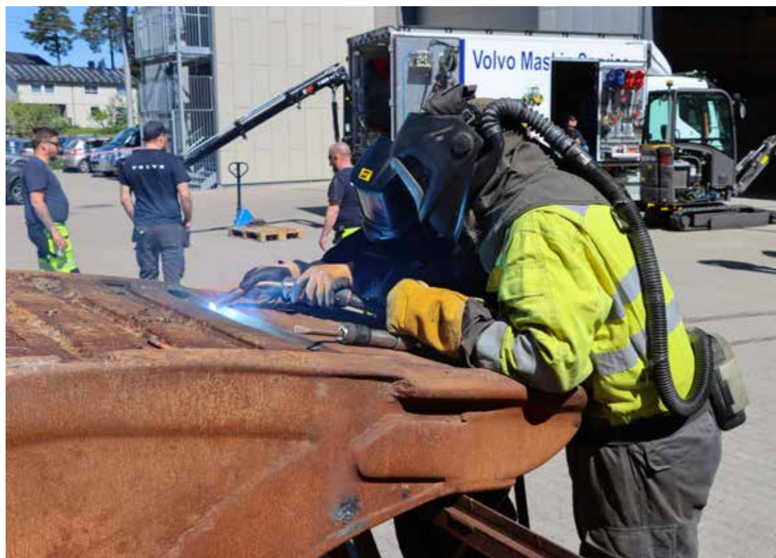
Elevene fikk prøve å sveise på en grave-maskinskuffe. Tidligere Volvo Maskin-ansatt og nå lærer ved skolen, Lasse Nordli, instruerte i hvordan få best mulig sveis.
