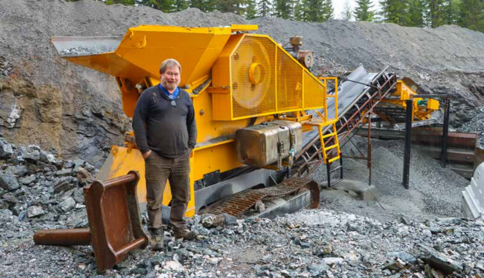
Knuseren og sikteverket har Torstein Vik konstruert og bygget selv. Knuseren er basert på en stasjonær elektrisk Aker-knuser, produsert på Trondheim mekanisk verksted (TMV) i 1984. Understellet kommer fra en O&K RH14 forgraver. El-motoren er byttet ut med en Volvo Penta dieselmotor.
