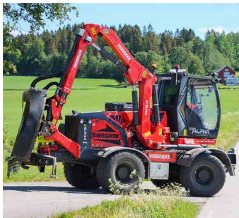
Klippeaggregatet pakkes inn bak på maskinen under transport.
