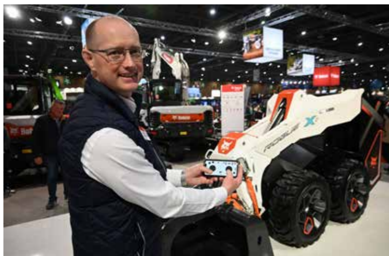
Med Bobcats egen app kan RogueX2-lasteren enkelt fjernstyres av en operatør, forklarer Acceleration Manager, Dennis Agnew i Bobcat.
