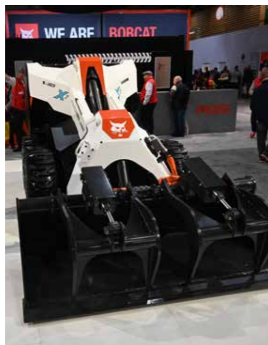
RogueX2 er en helt ny type anleggsmaskin, spesielt designet og bygget uten førerhus. Ved første øyekast minner den om en Formel 1 bil.
