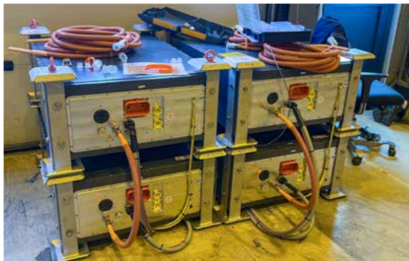
Hjullasteren skal utstyres med en batteripakke på 256 kWh. Det skal gi nok energi til minimum åtte timers drift.
