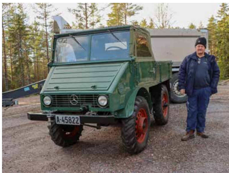
Dette er Unimog nr. 2 solgt i Norge, og registrert første gang 22. januar 1954. Dieselmotoren er på 1767 cm 3 og yter 18,3 kW/24,9 hk. Den eies av Bertel O. Steen, og historieguppen sørger for vedlikehold og at den får luftet seg med jevne mellomrom. Tommy Andre Hagen er blant ildsjelene i historieguppen og er fadder for Unimogen.
