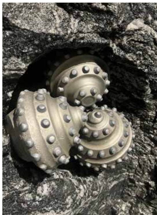
Boringen utføres med rullekrone. Dette er samme boremetode som brukes når det bores etter olje og gass. (Foto: Bortech)
