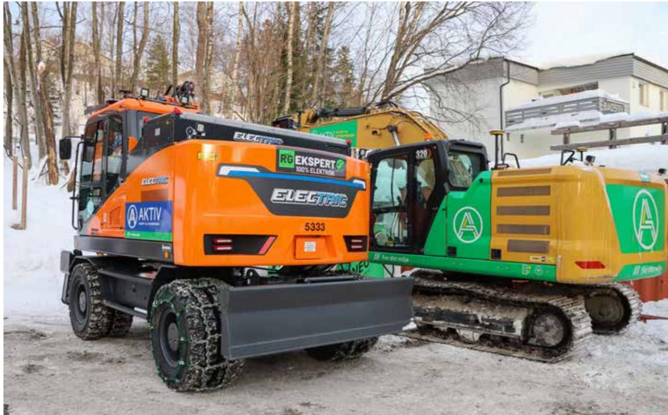
ELEKTRISK: Kun to elektriske maskiner brukes på prosjektet – Cat 320 Z-line og Develon (Doosan) DX165WR Electric. Sistnevnte ble levert dagen før, og er utstyrt med den nyeste batteriløsningen, som er på 385 kWh.
