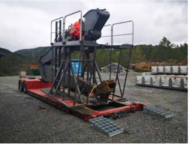
TRANSPORT: 480-en reduseres fra 64 til 41 tonn for transport på vestlandske veier. (Foto: Sartor Maskin AS)
