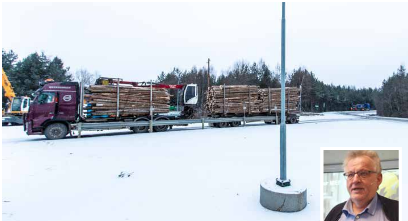
FOTO: Her blir et lass tømmer registrert og fotografert på Sørli tømmerterminal. I løpet av en dag eller to blir lasset målt fra bildet. (Foto: Jørn Söderholm)
