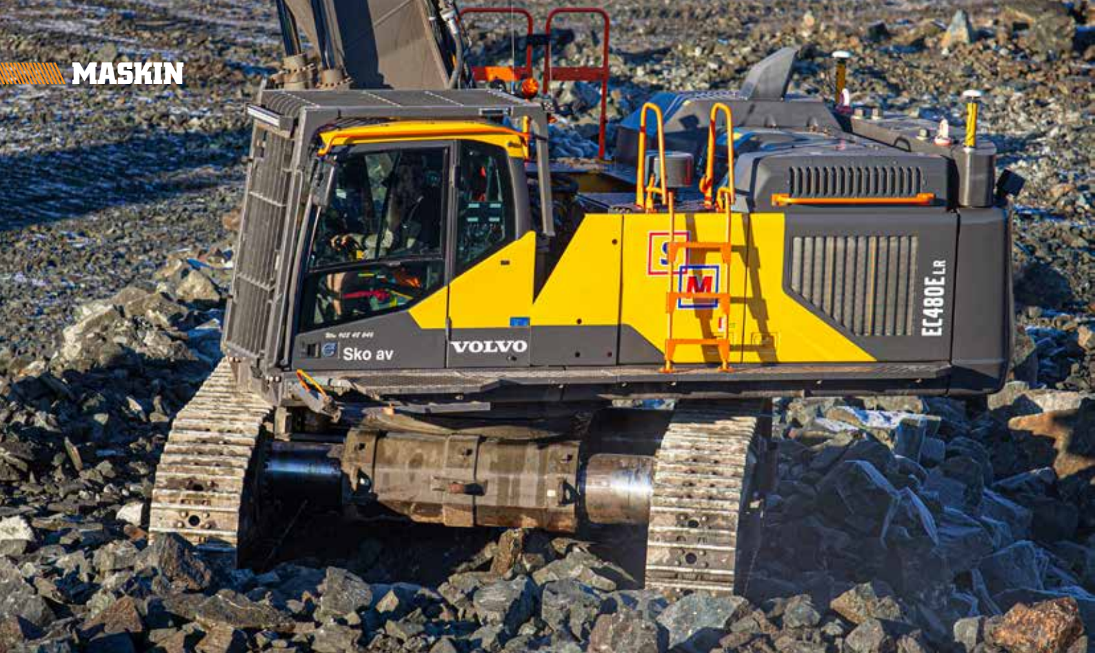
BRED: Undervogna er fire meter bred i arbeidsstilling. Kan dras inn til tre meters transportbredde.
