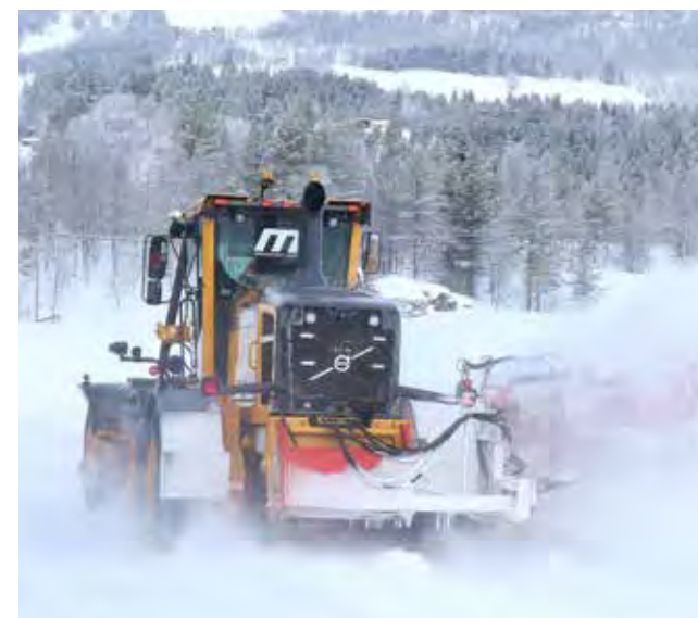
RØMMER: Vingen på høvelen er effektiv for å rømme snøkantene.
