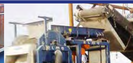
Virvelströmsseparator VS1200 Separering av alu, koppar, zink...
