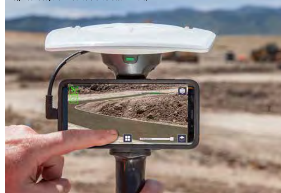
VISUALISERER: SiteVision kombinerer bilde og modell, og viser det på en mobiltelefon. (Foto: Trimble)
