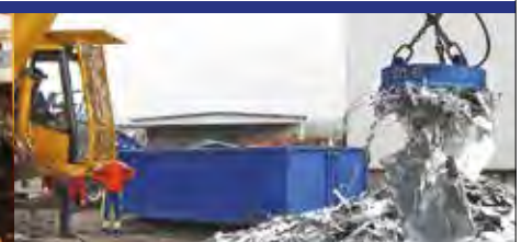
Lyftmagnet LM1300 Hantering av järnskrot
