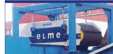
Magnetseparator MS1000S1200 Separering av järn
