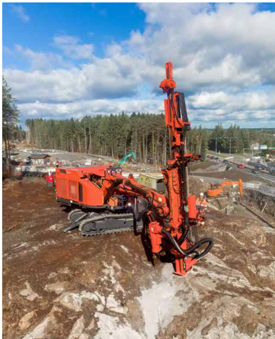
De nye DXR boreriggene er designet for 64–127mm (2½–5") hull, med borstangstørrelser 38–51mm (1½–2").
