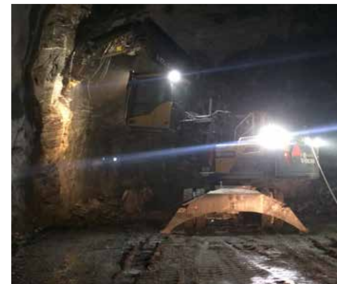
VANLIG: Implenia har RABS frontrute og vanlige sidevinduer på sine piggemaskiner. (FOTO: EGET)
