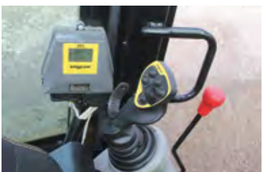
VENSTRE: Spakfunksjonene er enkle å stille inn. Tiltrotator og Engcon-displayet er ekstra-utstyr.
