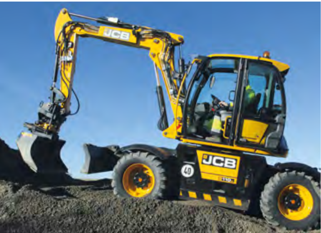
ANNERLEDES: Motor eksosrør sitter i undervogna. Eksos kommer inn dør eller vindu når overvogna er svingt med døra i nærheten av eksosrøret.
