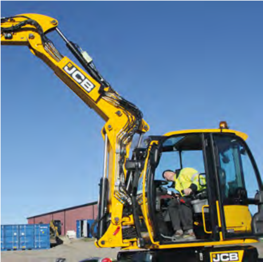
HØYT: Bjelken øverst i frontruta hindrer sikt ved høy lasting.
