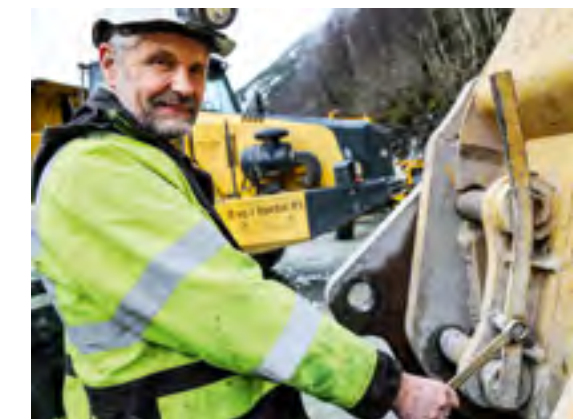
ENKELT: Jan Arild Bjordal demonstrer hvor lett klaffen løsnes og festes med en bolt.
