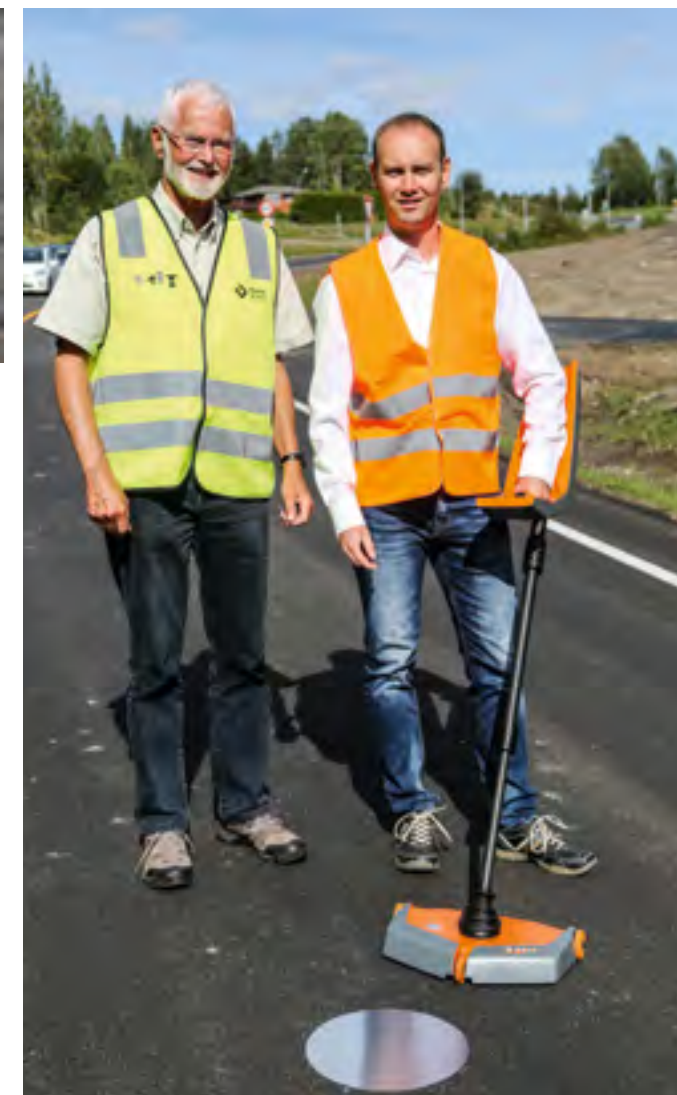
SAMARBEID: Stian Holte fra Holte Electronics og Matthias Herold fra MIT Dresden. Foran sonden ligger den runde aluminiumsplatene, eller reflektoren, som må ligge under asfalten for at målingen skal kunne utføres.
