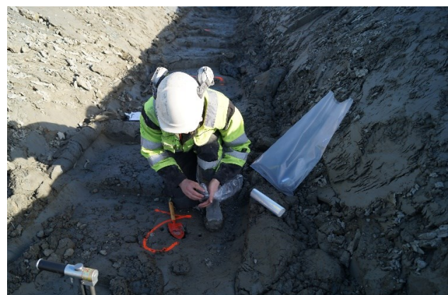
Figur 26 Prøve for kontroll av vanninnhold. Foto: Enoch By
