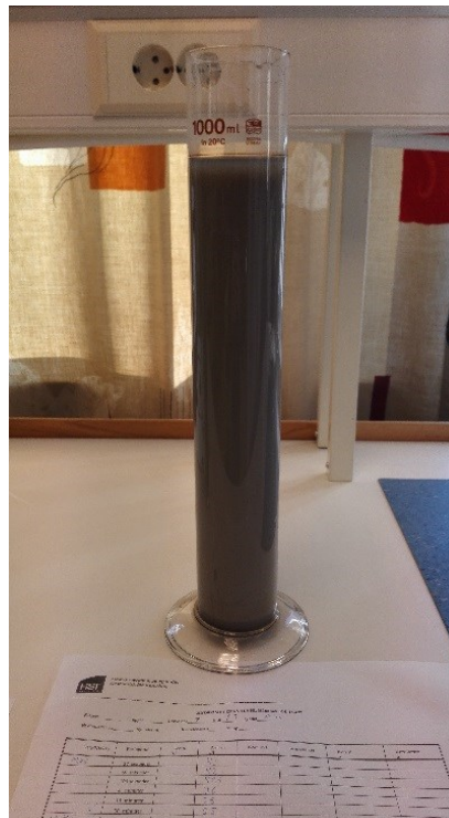
Figur 6 Prøve 7 fra hull P3. Siltig leire. Foto: JMSH
