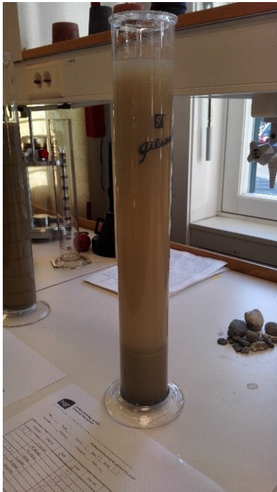
Figur 8 Prøve 3 fra hull P2. Leirig silt. Foto: JMSH
