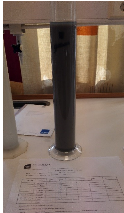
Figur 9 Prøve 5 fra hull P4. Leire. Foto: JMSH
