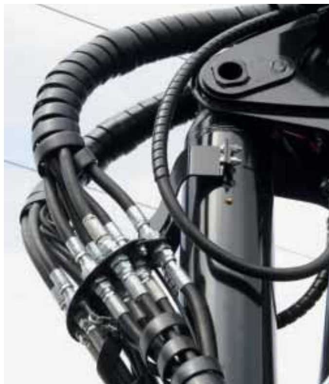
Skjøtesentral Her passerer alle slanger til kran og gripeklo.
